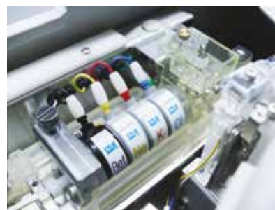
Ионоселективный модуль - 600 тестов в час
